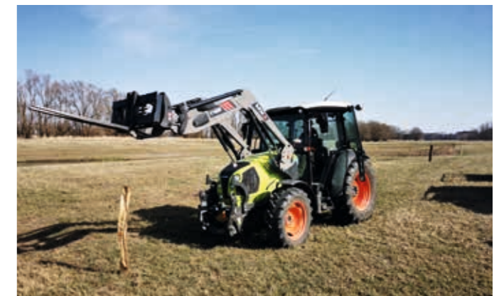
Aufstellen eines Zaunpfahls (© BRV/ J. Wübbenhorst)
