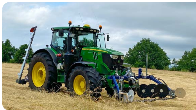
Moderne Doppelmesserkombinationen bewähren sich sowohl bei überständigen Grünlandbeständen als auch in unebenem Gelände.
