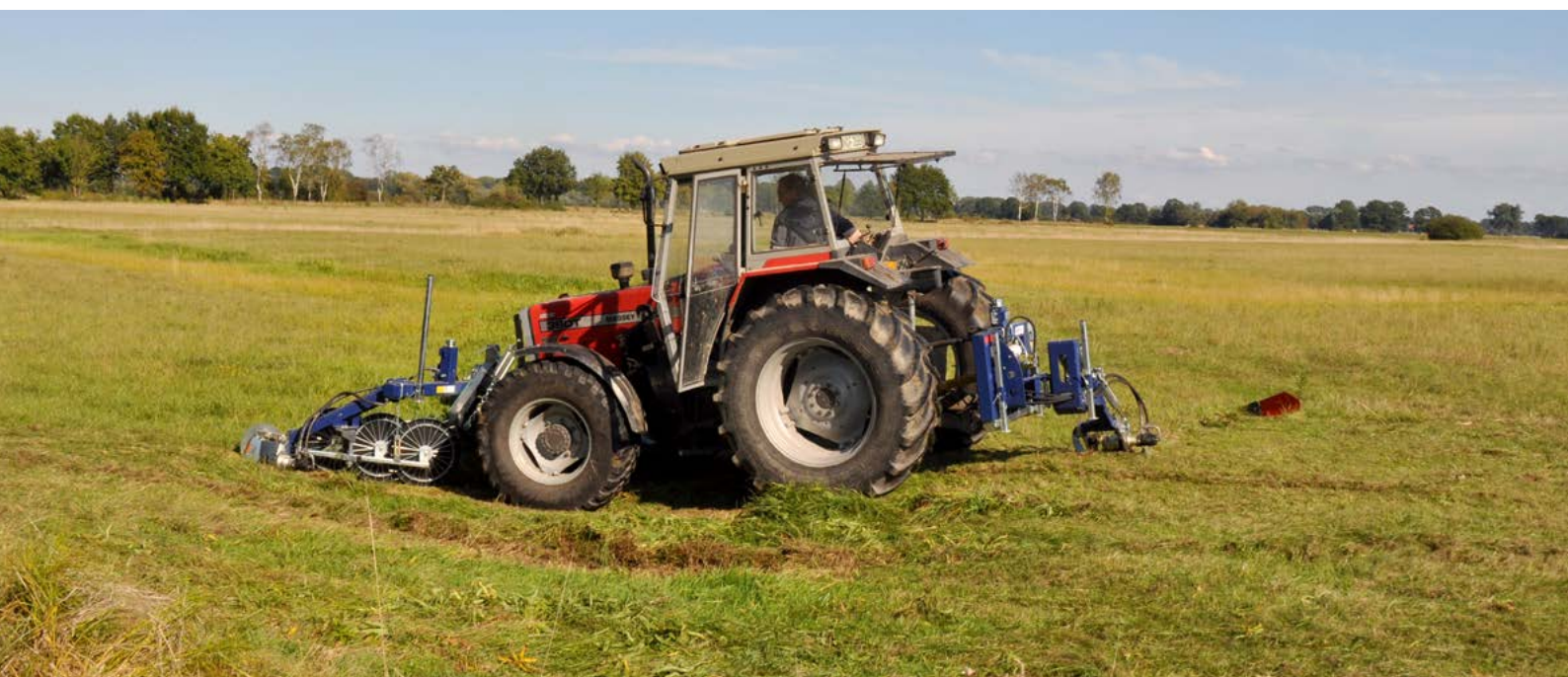
Moderne Doppelmesserkombinationen bewähren sich sowohl bei überständigen Grünlandbeständen als auch in unebenem Gelände.
